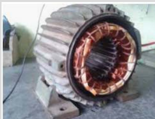
Bobinas de motores
